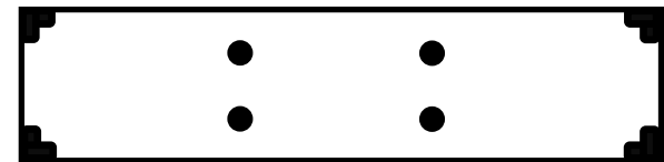
231, 232 Placering af vinkelben og justeringsskruer Placement of aluminum stands and adjustment screws Platzierung von Winkelbeinen und Justierungsschrauben
